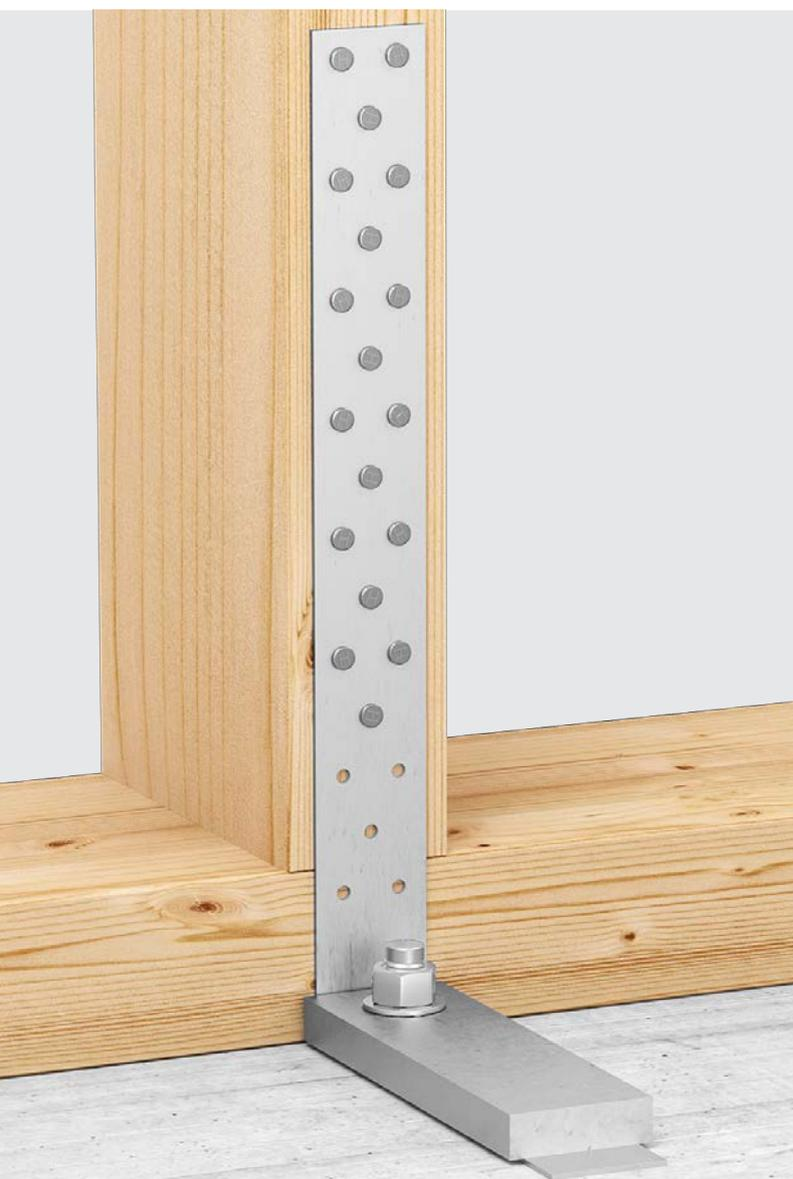
Die Zuganker inklusive Druckscheibe werden als klassische Zugverbindung von Holzbauteilen mit Anschluss an Beton verwendet. Fußpunktverankerungen im Holzrahmenbau werden mit diesem System schnell und einfach gelöst. Durch die großen Fußplatten inklusive der Druckplatten werden die Lasten statisch nachweisbar in den Beton eingeleitet und Holzkonstruktionen können so optimal mit der Betonunterkonstruktion verbunden werden.
