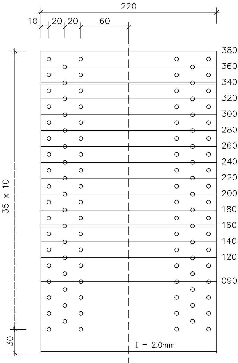
Alle Bohrungen  $\varnothing 5\text{mm}$
