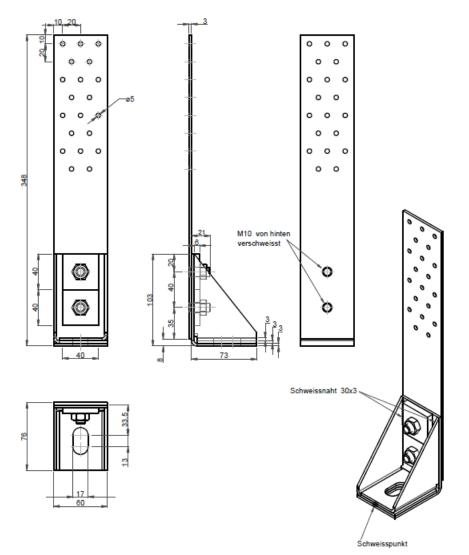
Figure B.38 HT2-G-Stegwinkel-2Bo-Z-102
