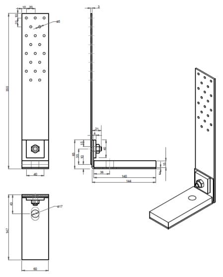
Figure B. 36 HT2-G-Druckplatte-lang-Z-316
