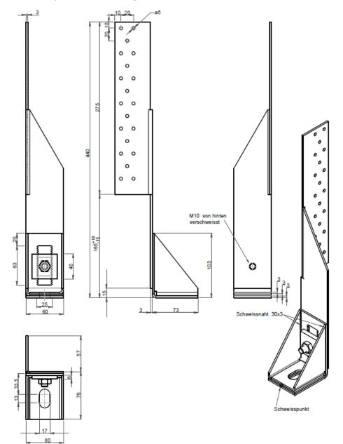
Figure B. 43 HT2-LV-425-Stegwinkel-Z-230
