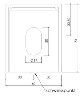
Figure B.56 GH-HT2 SB Fusswinkel mit Steg 60x73x60x3,0
