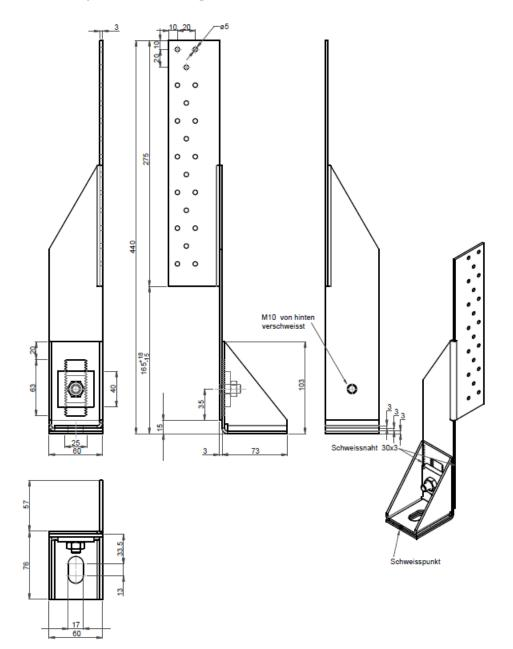
Figure B.45 HT2-RV-425-Stegwinkel-Z-235
