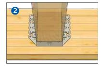
Montage au milieu ou affleurement en haut Si la poutre principale est montée au milieu de la poutre principale ou qu'elle l'affleure par le haut, les deux aides de montage sont directement enfoncées sur le trait métrique. Cela permet de monter et de fixer le TOP M sans outil supplémentaire.
