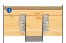
Monter l'aide au montage brevetée sur le bord inférieur et fixer le sabot à ailes extérieures en exerçant une légère pression sur les broches de montage.
